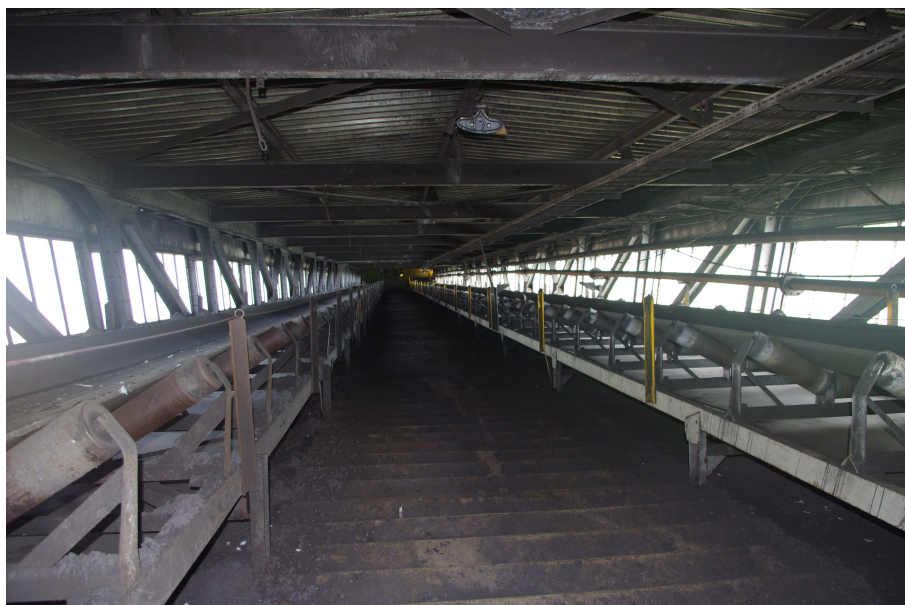
Fot. 51 Most przenośnikowy - wewnątrz, przenośniki taśmowe.
